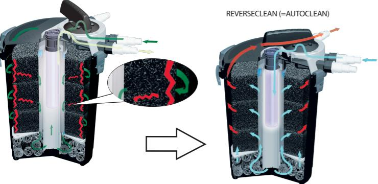
**PL** W przypadku silnego zanieczyszczenia mediów filtracyjnych lub wyraźnego spadku ciśnienia wody można skorzystać z trybu samooczyszczania REVERSECLEAN (=AUTOCLEAN) (sugerowana częstotliwość – raz w miesiącu). Jeśli nie przyniesie to zakładanego efektu wówczas media należy oczyścić ręcznie, używając wody ze zbiornika.
